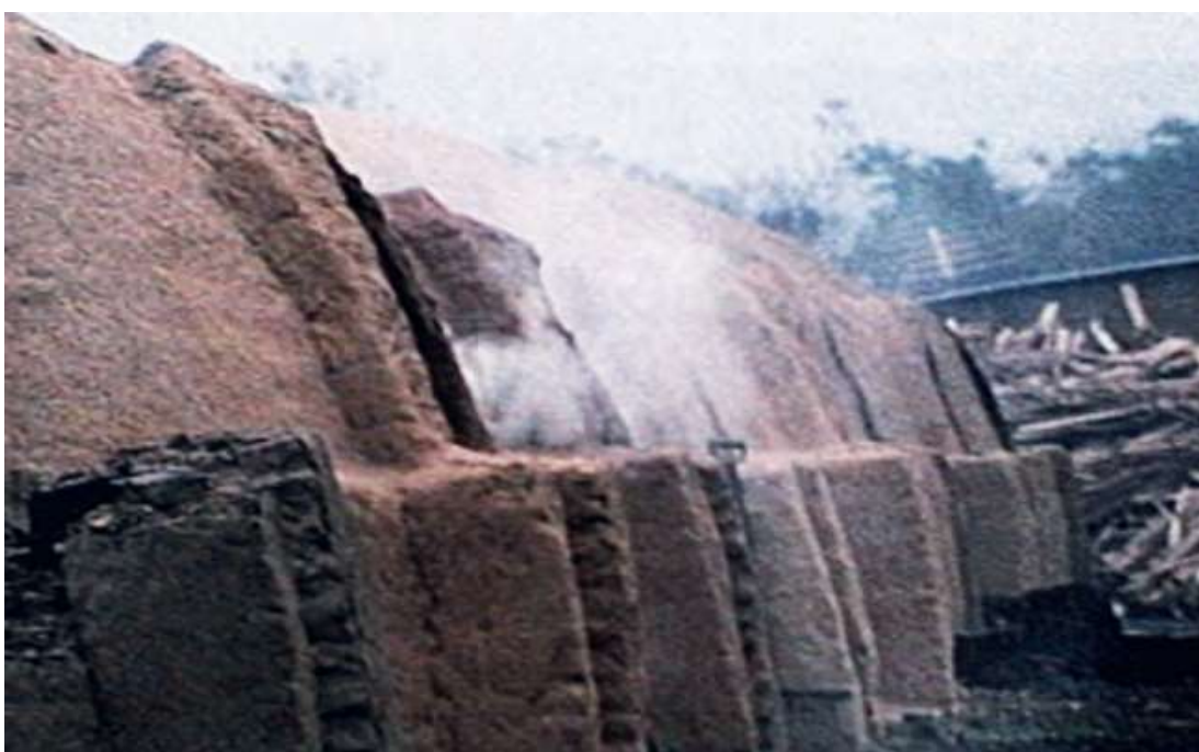
Foto 4 – Bateria de fornos para produção de carvão vegetal, encontrados em várias municípios do Pará e do Maranhão, para atender as usinas siderúrgicas de ferro-gusa do Programa Grande Carajás, maio de 1991 (foto extraída do Filme Fronteira Carajás , direção de Edna Castro, direção de Fotografia de Chico Botelho, arquivo Cabocla Filmes).
